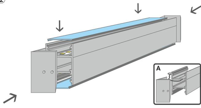
Applicare le staffe e se richiesto fissarle con le viti in dotazione, quindi inserire la copertura. L'uscita del cavo di alimentazione è posteriore (passaggio attraverso lo spazio laterale della staffa, esempio A).
