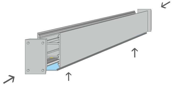
Applicare i tappi e se richiesto fissarli con le viti in dotazione, quindi inserire la copertura. L'uscita del cavo di alimentazione è superiore.
